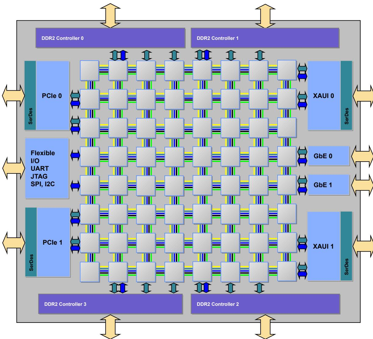
单颗 TileraPro64 CPU 集成了 64 颗 866Mhz 的计算内核，4 个 DDR2 内存控制器，计算内核与内存之间的数据读写从此顺畅无比。尤其还集成了 2 个万兆网络控制器，摒弃了传统构架中的 PCI-E 总线的数据传输瓶颈。从此对于网络数据包能够真正达到了万兆级的处理能力。
